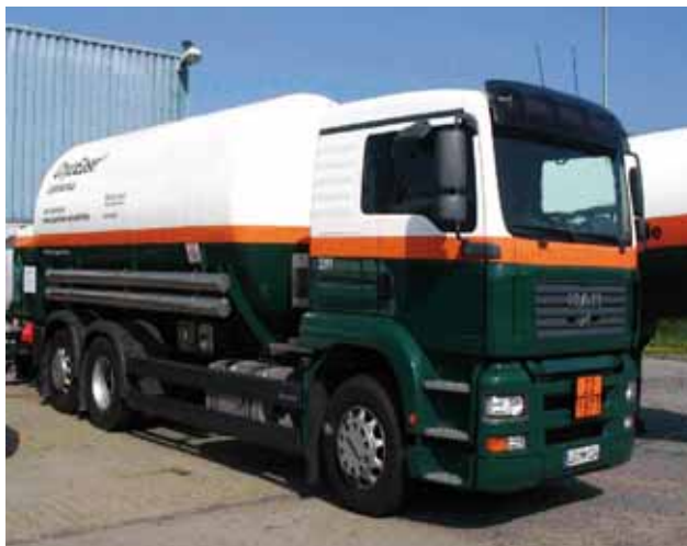
Obrázek 5: Autocisterna pro přepravu kapalných technických plynů
