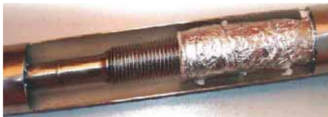
Obrázek 9: Konstrukce vakuově izolovaného potrubí
