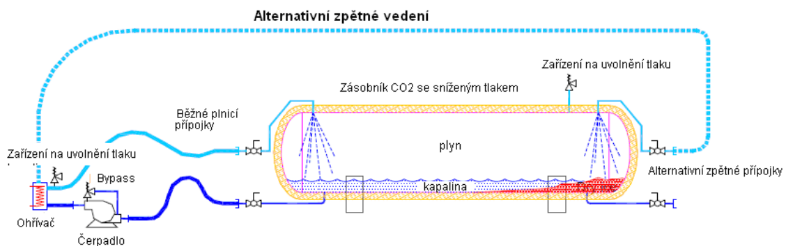
Obrázek 7 – Recirkulace ohřáté kapaliny na 1380 kPa (200 psig) (Viz kapitoly 13.5 a 15.3.2)
