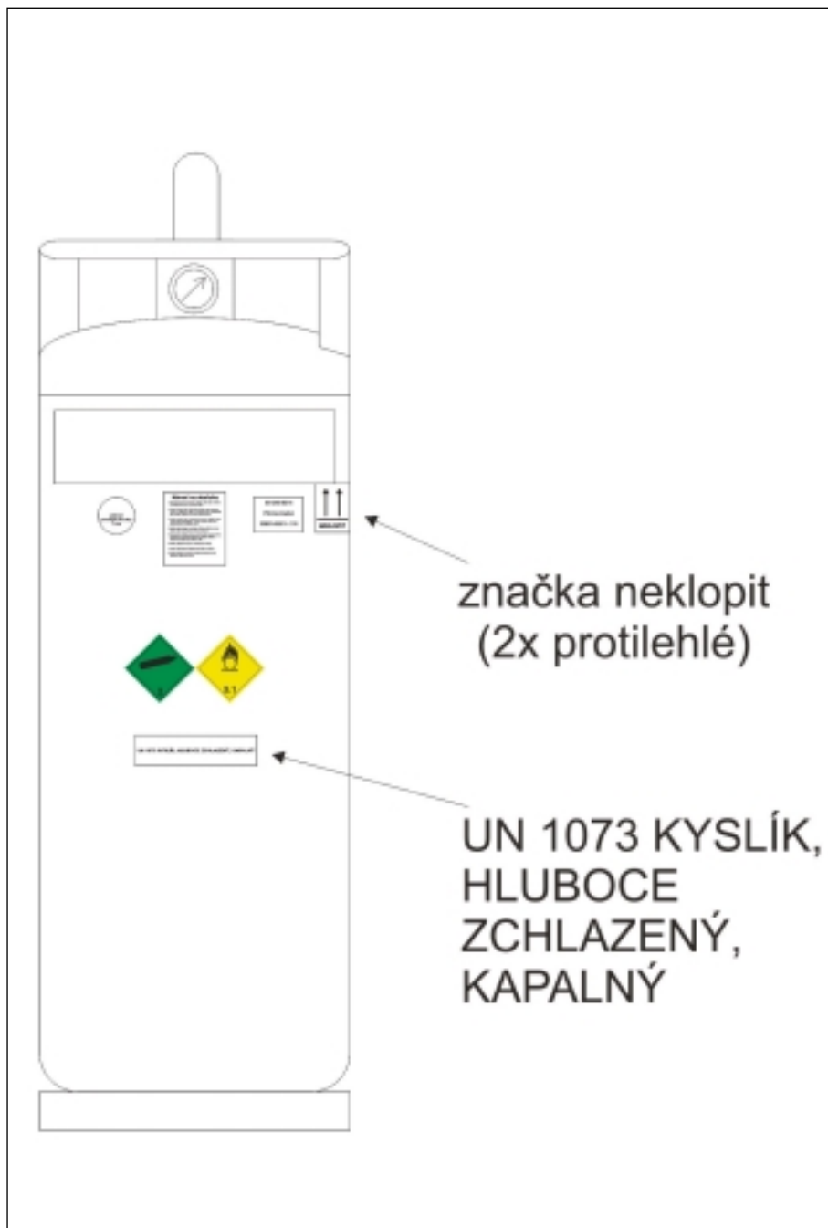
Příloha 4 – Značení kryogenních nádob (příklad kyslík hluboce zchlazený, kapalný)
