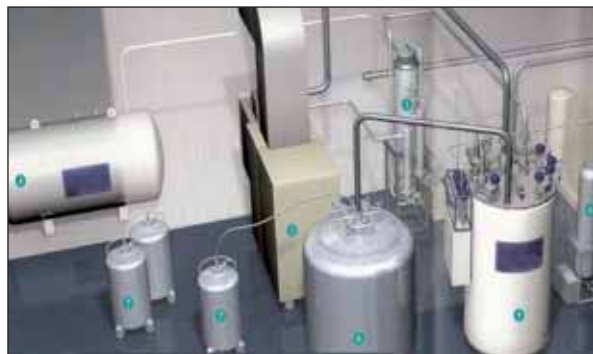
Obrázek 24: Uspořádaní laboratoře se zkapařňovačem helia
