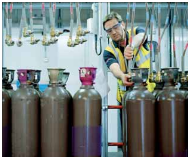
Obrázek 8: Plnění plynného helia do tlakových lahví
