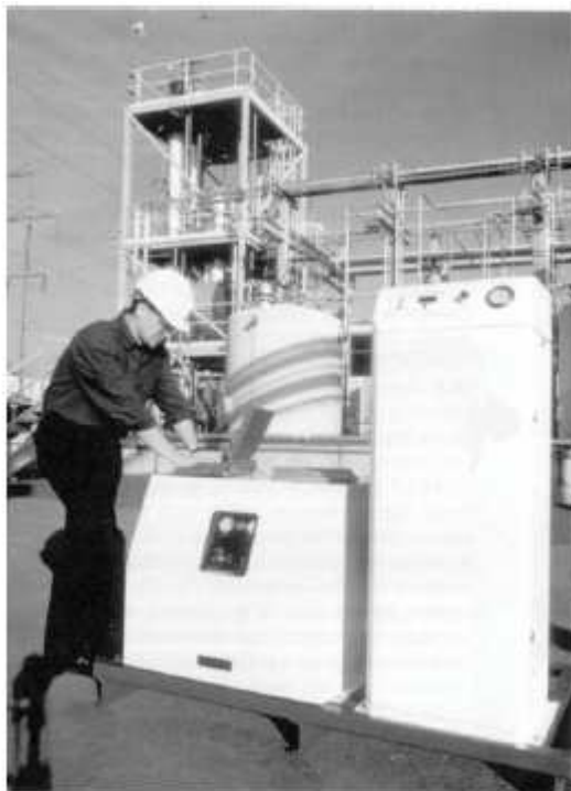
Obrázek 10 – Membránová jednotka na výrobu dusíku
