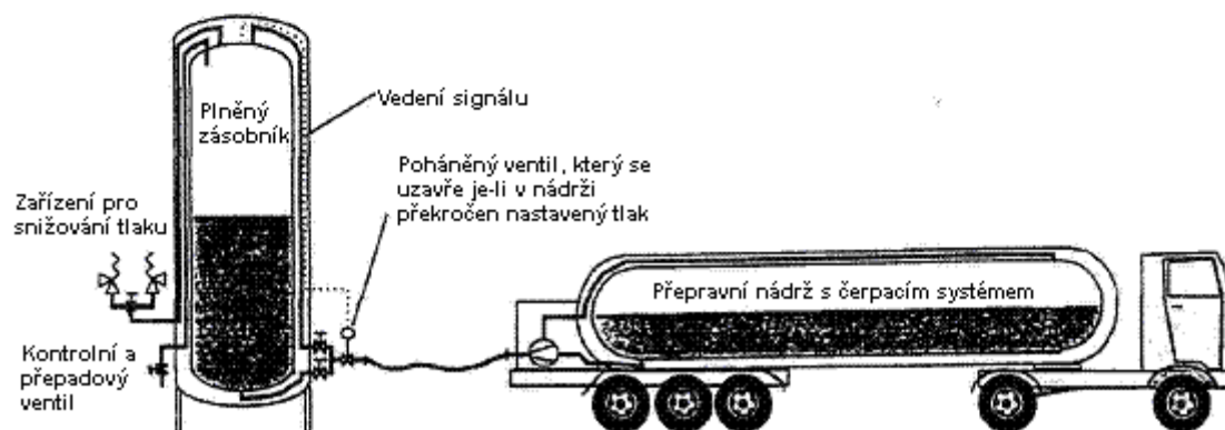
Obrázek 3: Zásobník se zařízením pro zastavení přívodního průtoku
