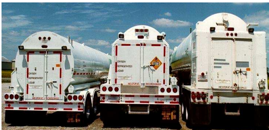
Obr 2: Přívěsy v provedení se sníženým těžištěm
