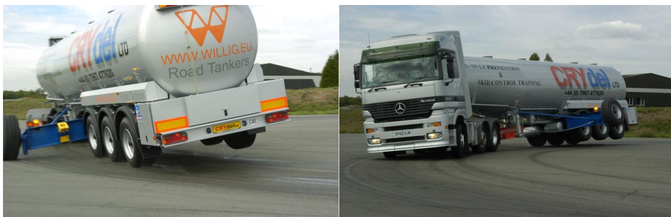
Obrázek 3: Speciálně upravené vozidlo pro praktický nácvik prevence převrácení
