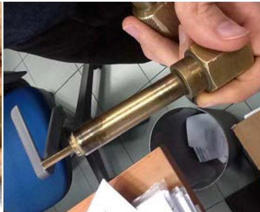
Obrázek 4: Poškozený adaptér (byla odstraněna převlečná matice, aby byla vidět chybějící část)
