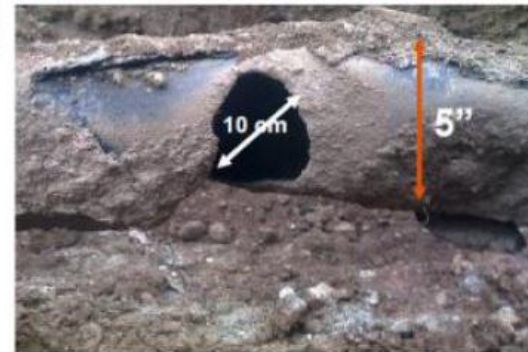
kyslíkové potrubí: Jmenovitý průměr: 5" Jmenovitý tlak: 25 barg
