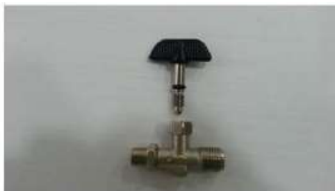
Ventil ve zcela otevřené poloze s uvolněným ovládacím kolečkem
