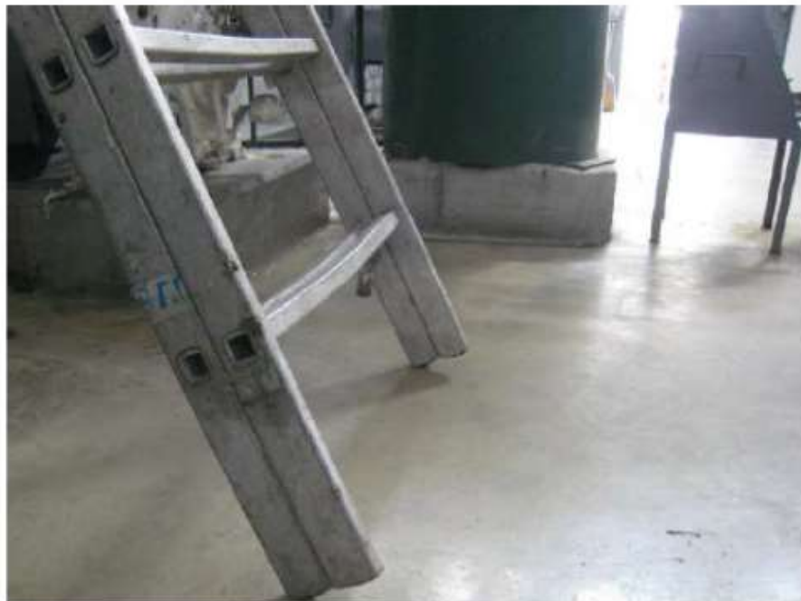
Štafle použité jako opřený žebřík, opotřebené protiskluzové patky a kluzká podlaha
