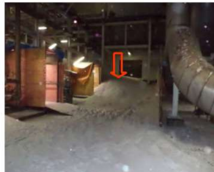
Východní strana chladicí jednotky po provedení počátečního čištění, kde se okamžitě po uvolnění perlitu vytvořila hromada cca 4 m perlitu. Šipka označuje místo nalezení oběti.
