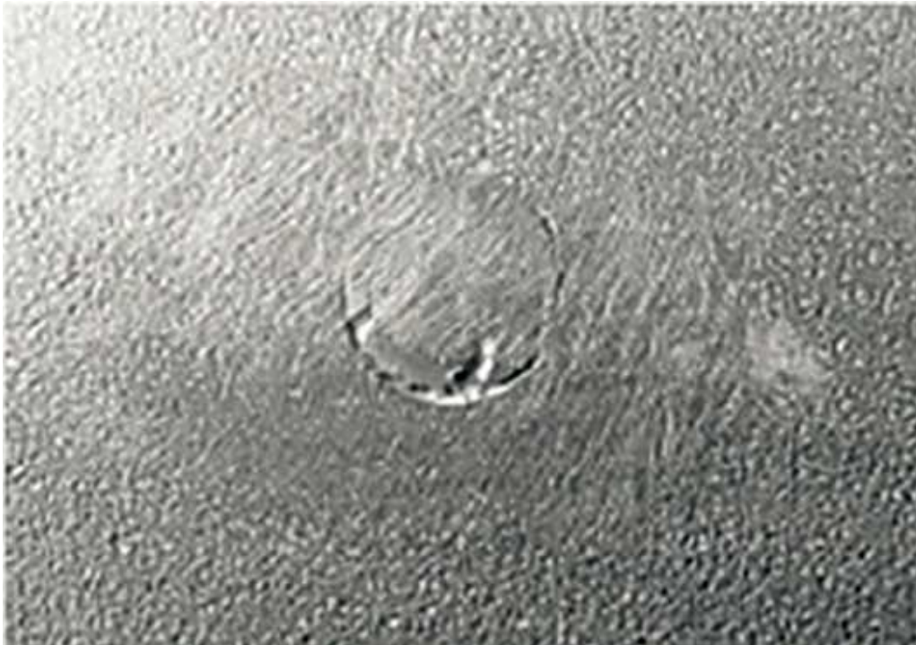
Lahev se zavařenou zátkou v tělese
