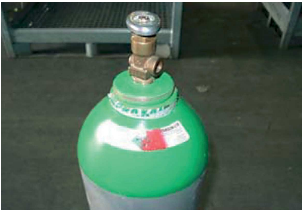
Acetylenová lahev upravená jako lahev pro argonovou směs
